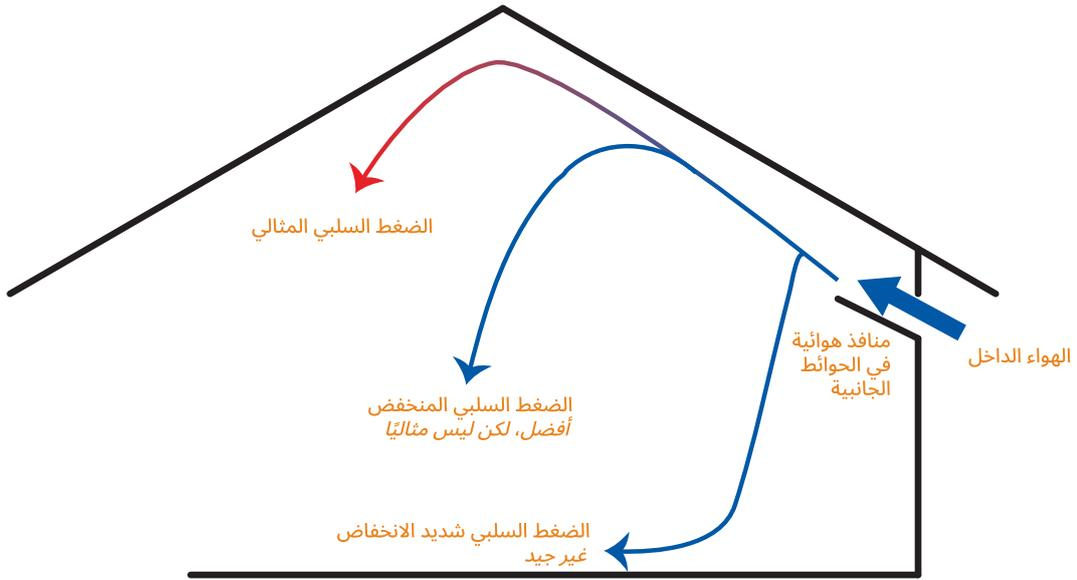
تضمن سرعة الهواء العالية أيضًا مزجًا جيدًا للهواء الداخل البارد مع الهواء الداخلي الدافئ الذي يتجمع في قمة العنبر (الصورة 6.6). هذا لا يجعل الهواء القادم أكثر دفئًا فحسب، بل يقلل أيضًا من رطوبته النسبية، مما يسمح له بامتصاص الرطوبة.
